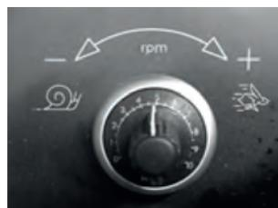
Stufenlose Geschwindigkeitsregulierung der Aggregate
