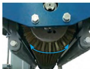
Gleich-Gegenlaufschtung der Bürstaggregate
