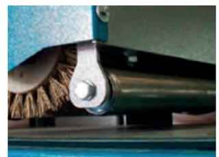
Oszillationseinrichtung der Aggregate
