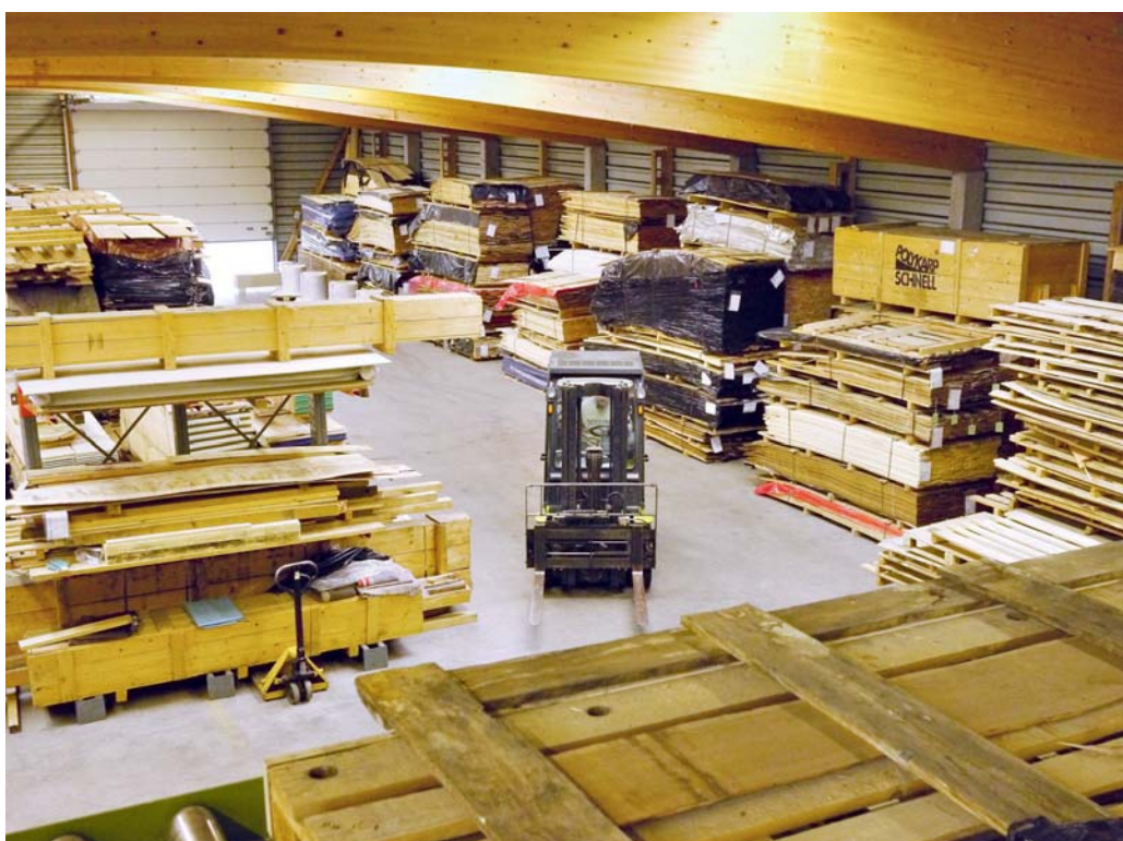
Blick aus der Produktionsebene im 1. Stock auf das Rohwarenlager, beschickt wird per Stapler auf die Rollenbahn vorne (Fotos: Koch)
