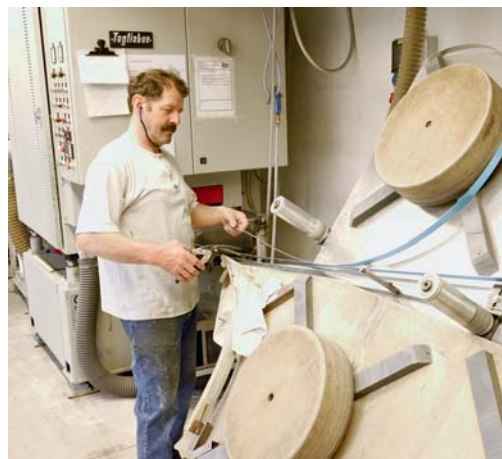
Aluminiumkanten vor dem Schleifauf-tomaten – Rol-lenwechsel
