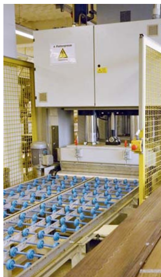
Presse für Holz- und Materialmix-Blockverleimungen sowie Hirnholzkanten-Rohlinge
